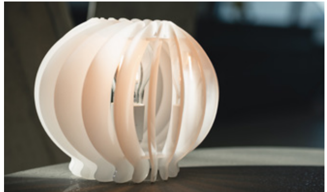
Bords de découpe d'acrylique brillants et polis à la flamme jusqu'à 15 mm
